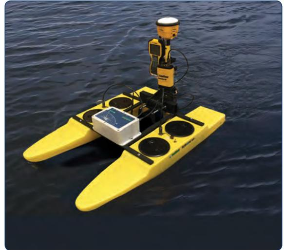
装配了HydroLite™勘察杆和AutoNav™自动导向器（自动行驶）模块的HyDrone
